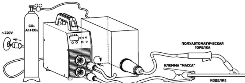
**Внимание!** В качестве защитного газа применяется при сварке чёрных металлов в простейшем случае углекислый газ "CO<sub>2</sub>", а при сварке алюминия только инертные газы типа аргон "Ar", иногда дорогой гелий "He", как альтернатива для нержавеющих и высоколегированных сталей часто применяются смеси в различных пропорциях "80%Ar+20%CO<sub>2</sub>". Использование других газов только по согласованию с производителем оборудования.
